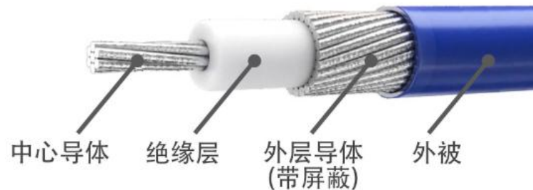
极细同轴线结构
